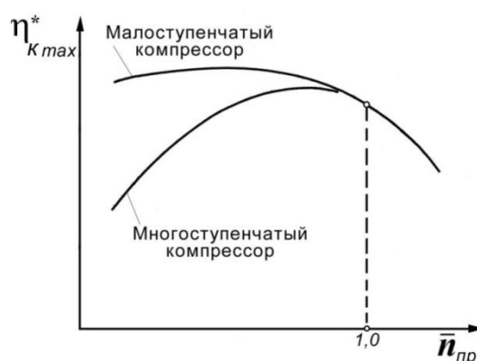
Рис. 3.5. Изменение КПД компрессоров с различным количеством ступеней при изменении n_{пр}
