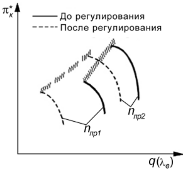
Рис. 3.9. Влияние регулирования компрессора поворотом НА на его характеристику
