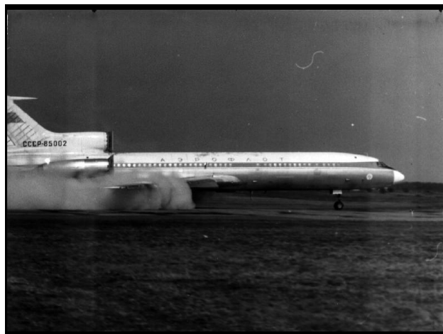
Рис. 8.1. Визуализация реверсивных струй на пробеге самолета Ту-154Б.
