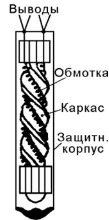
Рис. 1.3. Схема термометра сопротивления
