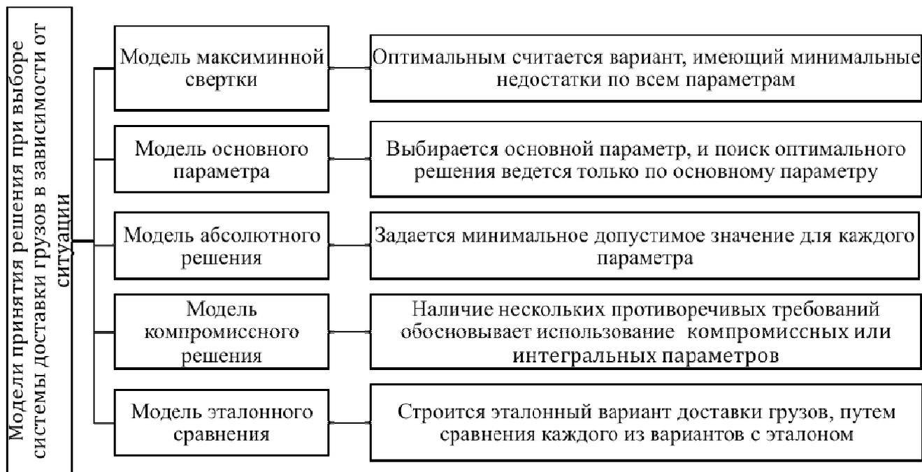
**Рис. 2.** Структурная схема моделей принятия решений при выборе системы доставки грузов
