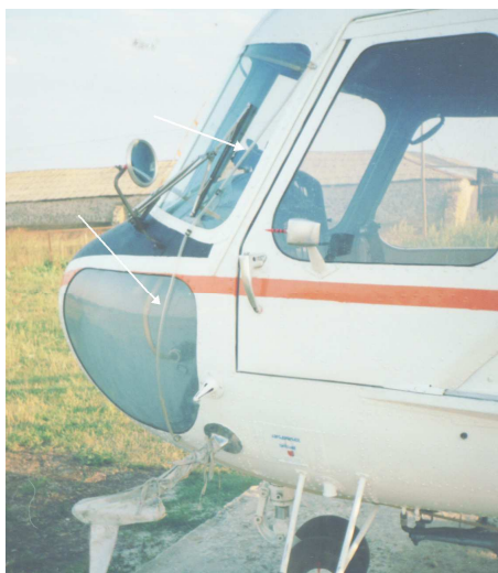
Рис. 1. Применяемый на сельскохозяйственных вертолетах «датчик» уровня химической смеси – прозрачная трубка вдоль остекления кабины (показана стрелками)
