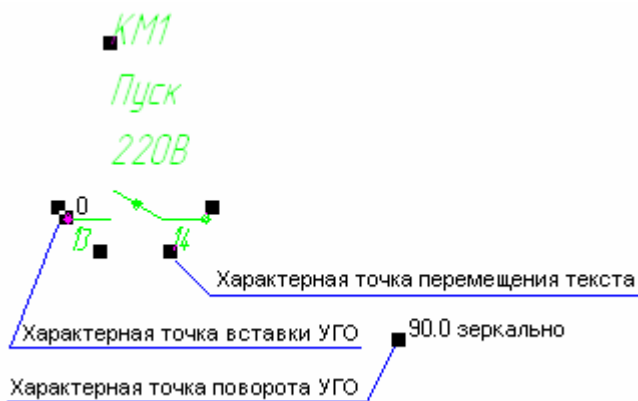
Рисунок 1. Характерные точки на УГО
