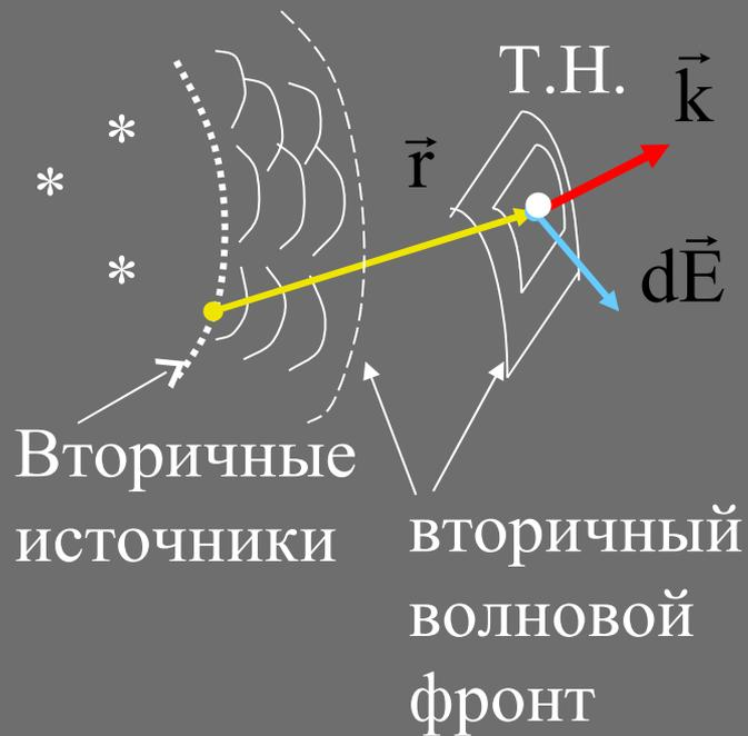
Каждый вторичный точечный источник создает в точке наблюдения (Т.Н.) волну, у которой напряженность электрического поля можно вычислить по формуле:
