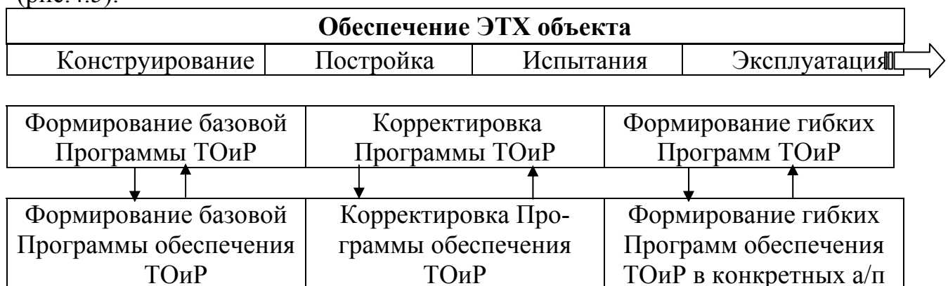
Рис.4.5. Схема формирования базовых гибких программ в привязке к стадиям жизненного цикла ВС
