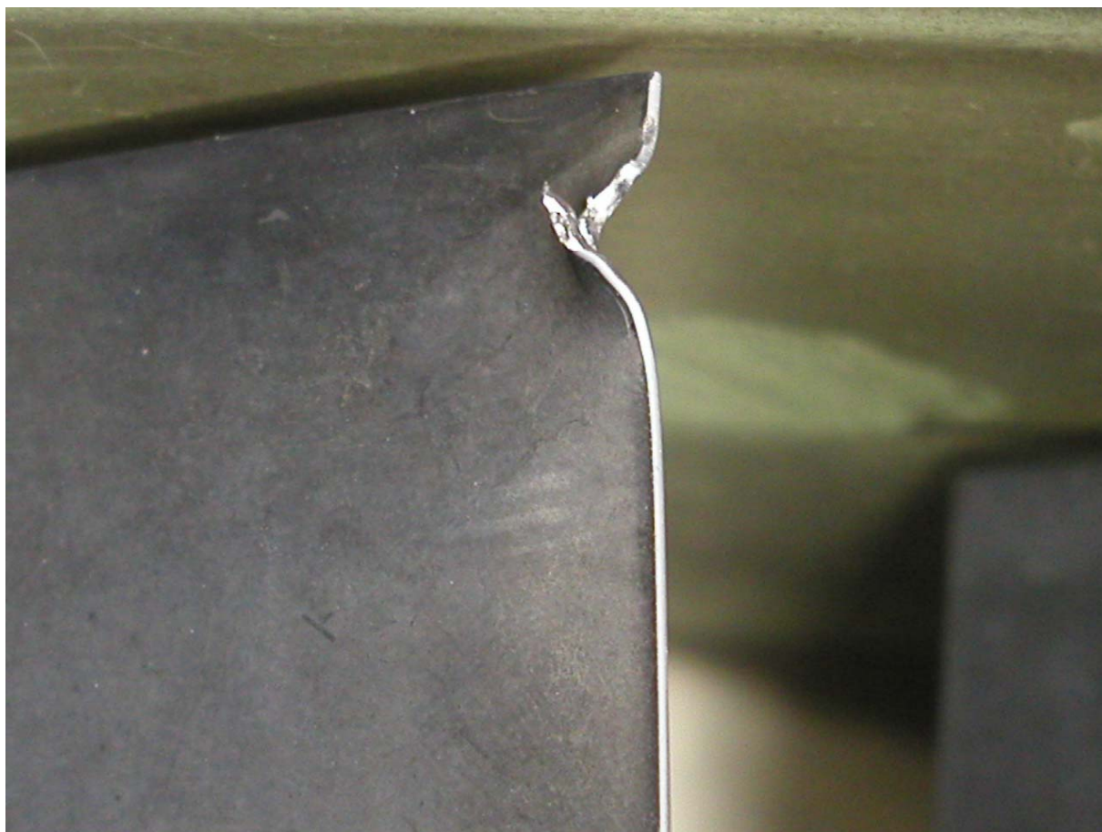
Рис.2.8. Забоина на входной кромке лопатки первой ступени вентилятора двигателя Д-30КУ-154
