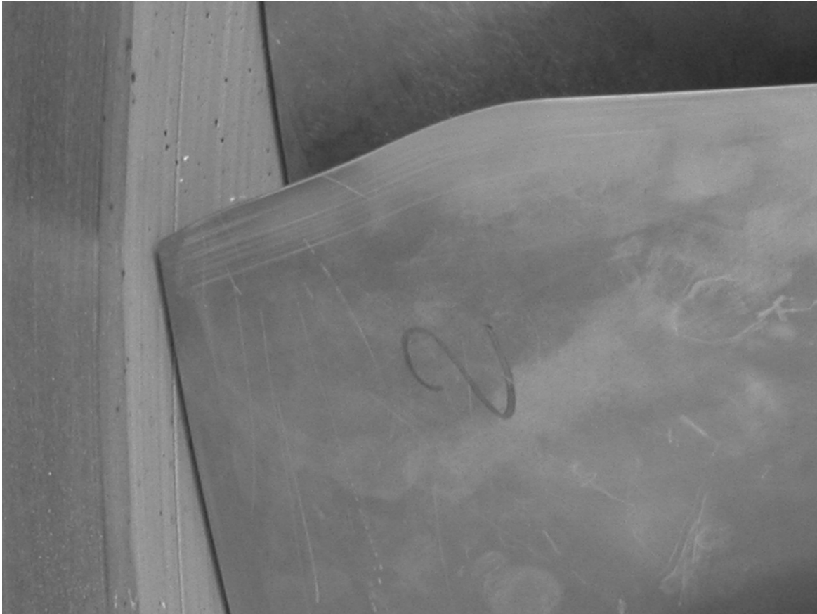
Рис.2.19. Лопатка вентилятора двигателя ПС-90А со спиленным уголком входной кромки
