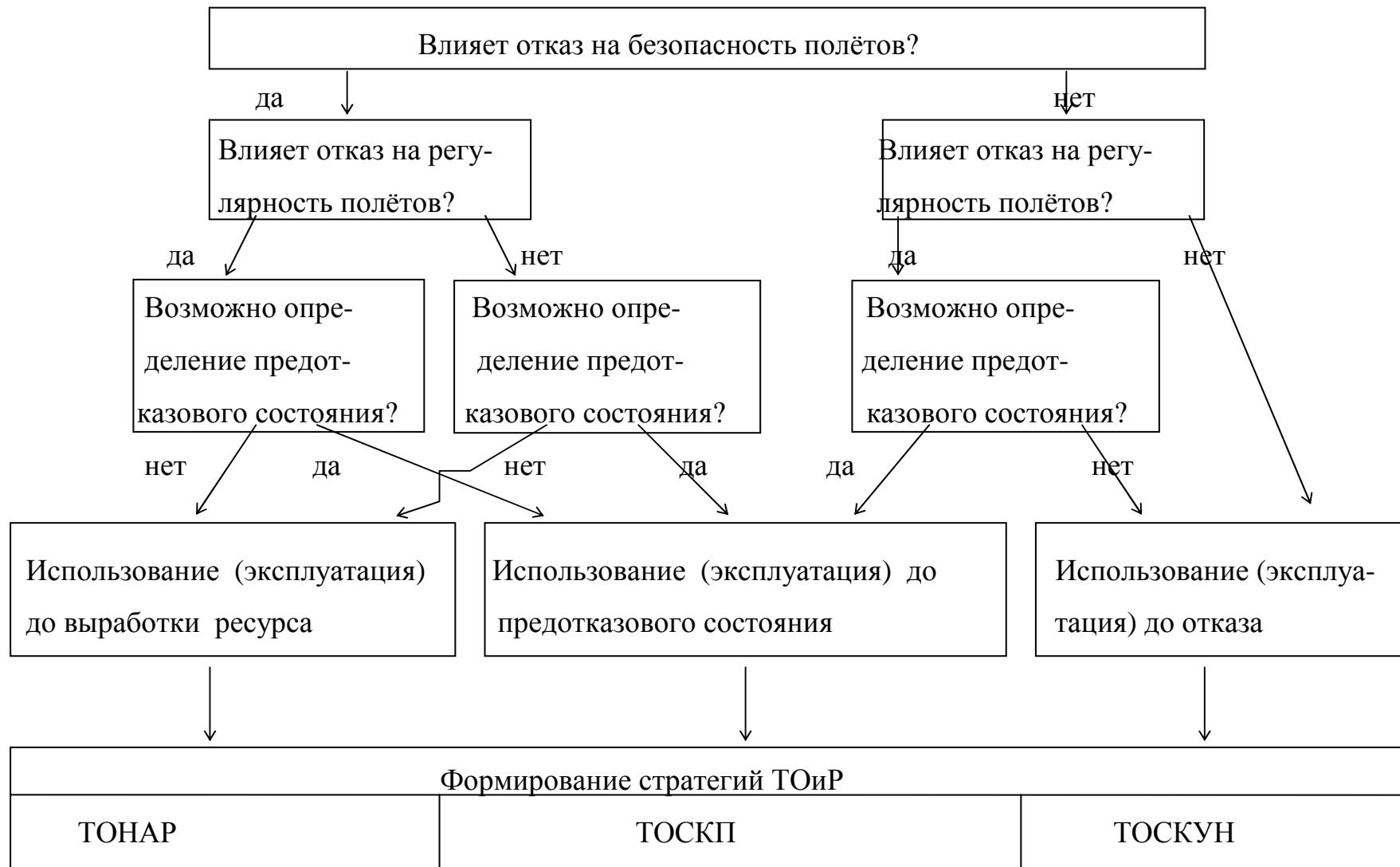
Рис. 3.5. Логическая схема выбора рациональных стратегий использования и ТО и Р для изделий ФС.
