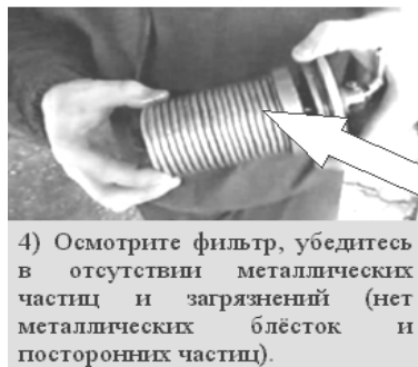
Рис.П2. Пример пошаговых фотоиллюстраций к проведению работ по МФС-30
