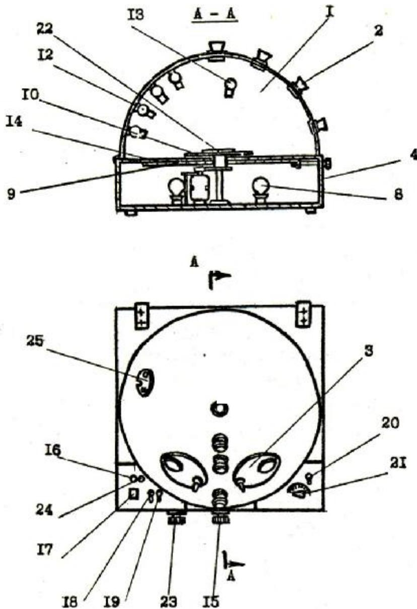
Рис. 4. Общий вид полусферической камеры стенда ОТ-8
