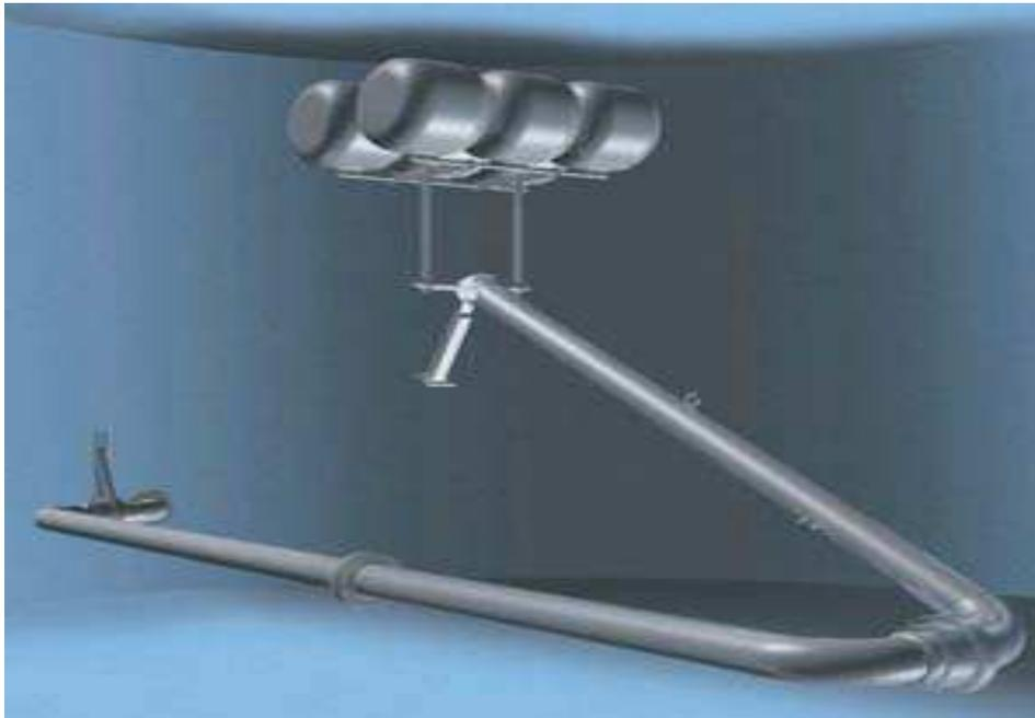
Рис. 12 Плавающее устройство верхнего забора
