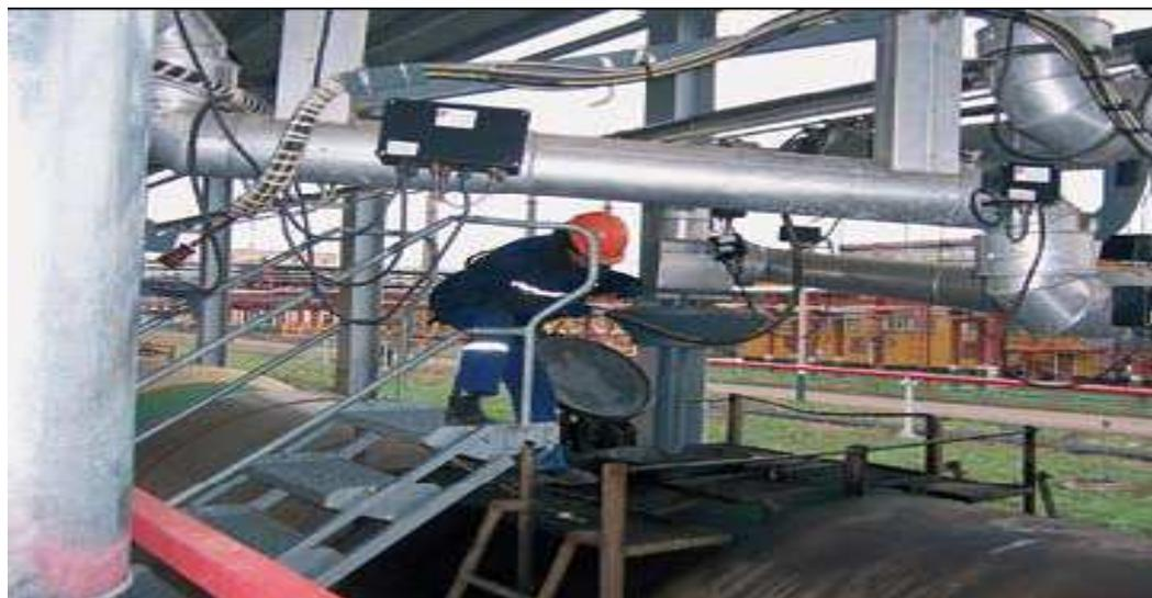
Рис. 40 Налив под днище ж/д цистерн
