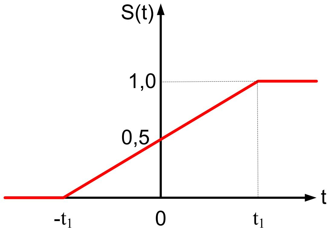
$$S(t)= \begin{cases} 0 & \text{при } t < -t_1 \\ 0,5 (t/t_1+1) & \text{при } -t_1 \leq t \leq t_1 \\ 1,0 & \text{при } t > t_1 \end{cases}$$
