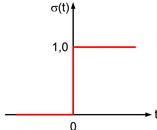
$$\sigma(t-t_0) = \begin{cases} 0 & \text{при } t < t_0 \\ 1 & t > t_0 \end{cases}$$
