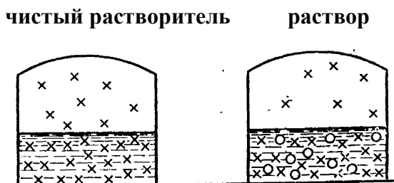
Рис. 8.2.1.1.1 Схема процесса образования насыщенного пара над чистым растворителем и раствором.
