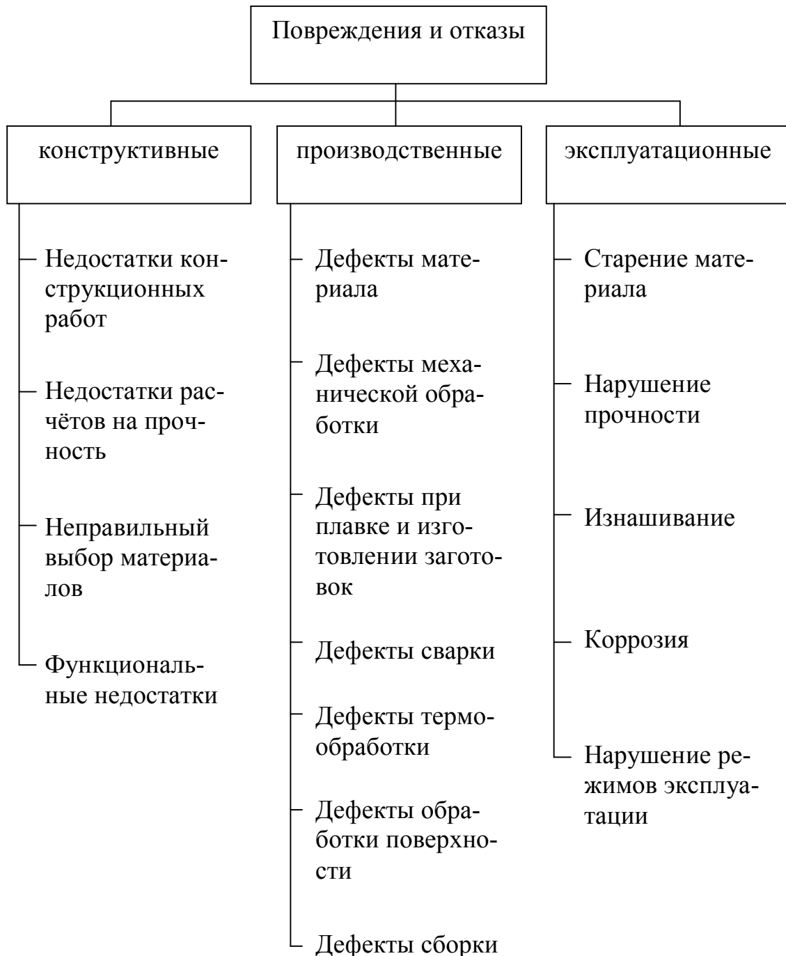
Рис. 1.2. Виды повреждений и отказов
