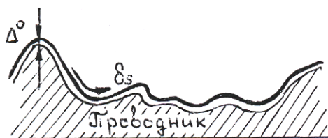
Рис.1.5. Эпюра изменения амплитуды объемной плотности тока проводимости на СВЧ в хорошем проводнике
