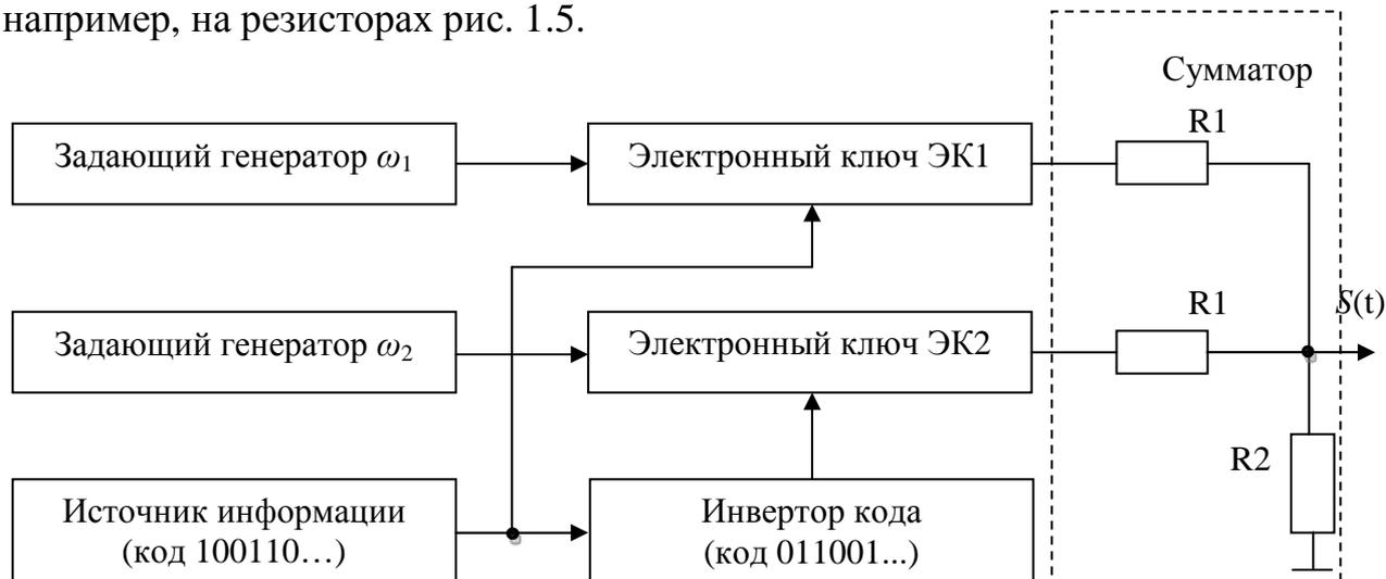
Рис. 1.5. Схема формирования ЧМн радиосигнала
