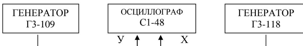
Рис.1. Схема соединений приборов при измерении частоты методом интерференционных фигур
