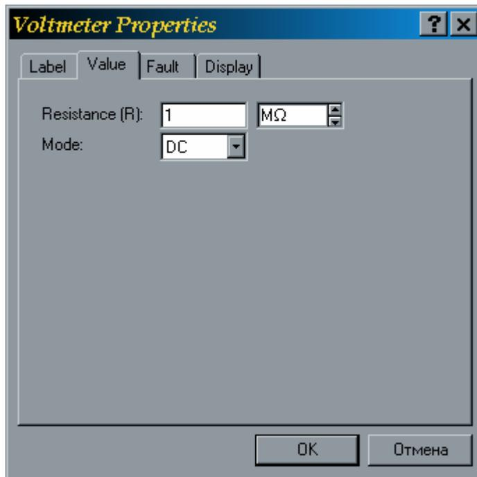
В поле Resistance указывается внутреннее сопротивление прибора, а в поле Mode – тип напряжения.
