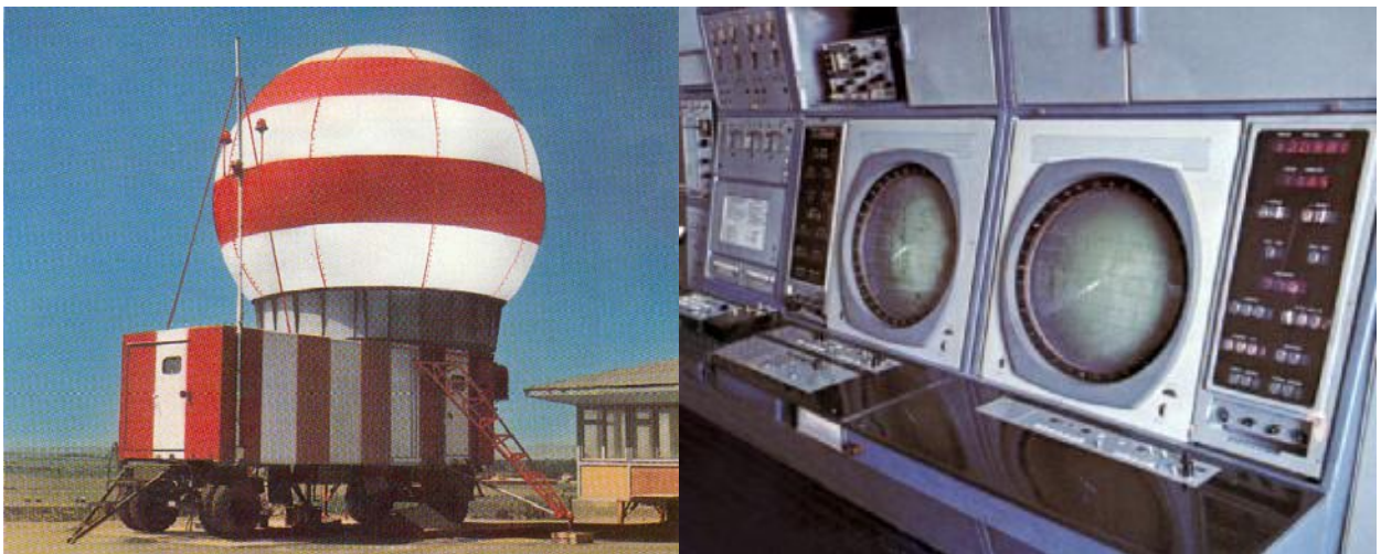
Рис. 3.6. Метеорологический радиолокатор МРЛ-5. Слева – внешний вид, справа – пульт технического контроля
