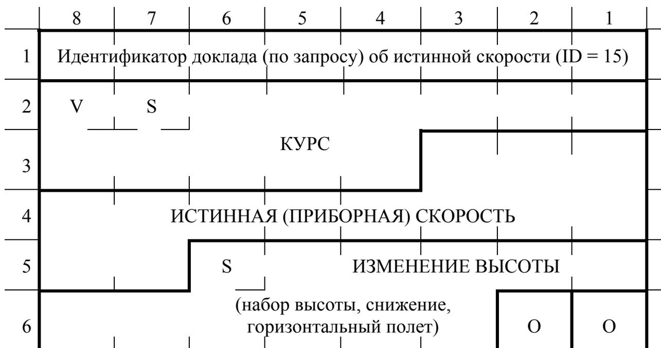
Рис. 4.5. Блок вектора истинной скорости ВС (включается по запросу)
