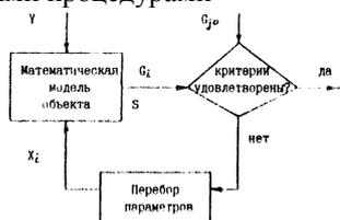
Рис. 2.11. Внутренний цикл параметрического синтеза
