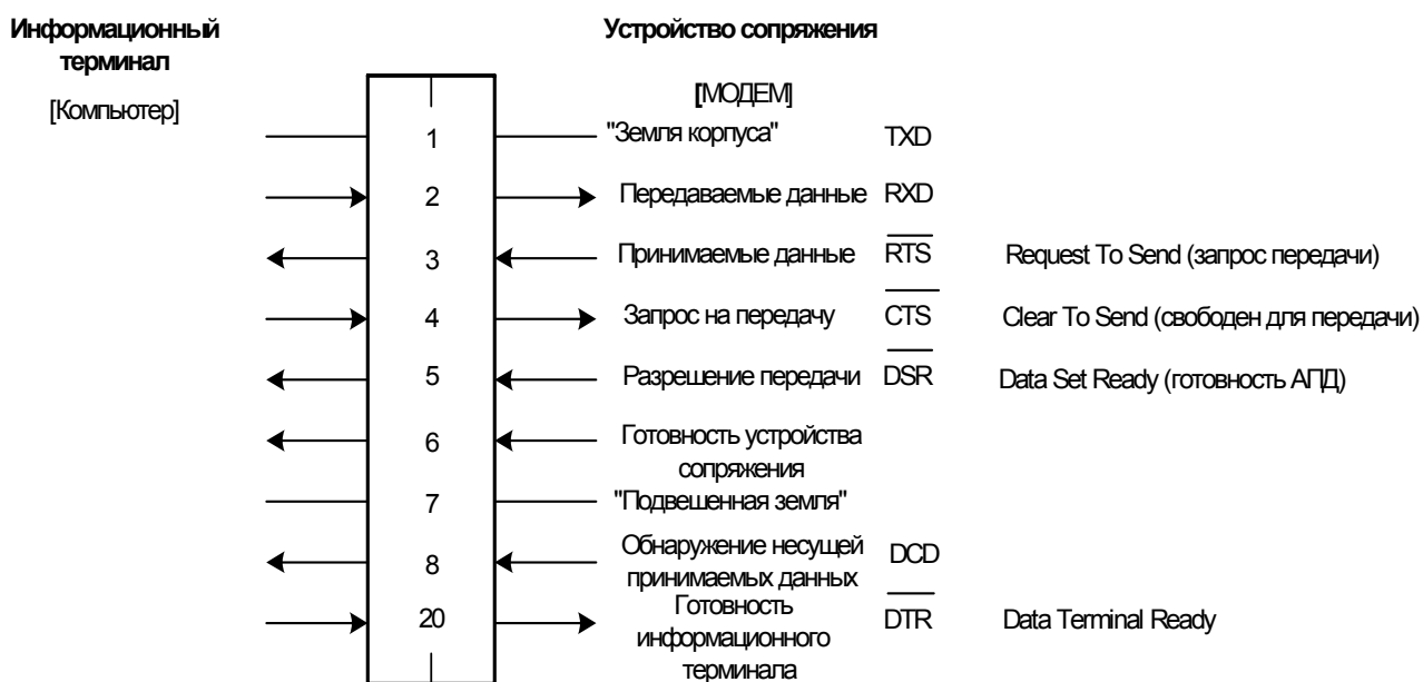
Рис. 3.14. Провода, используемые в устройстве сопряжения
