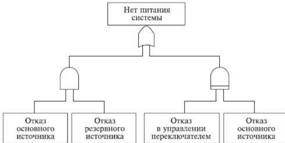
Рис. 3.5 Пример использования логического знака "приоритетное И"
