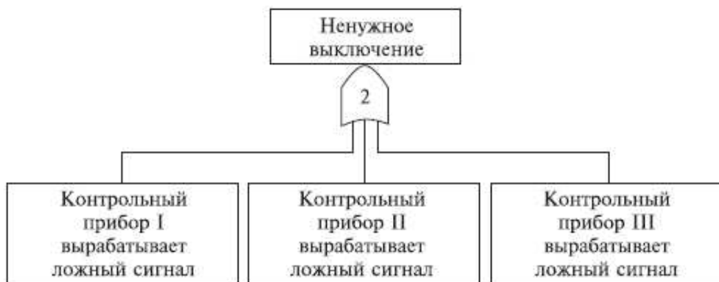
Рис. 3.8,а. Пример применения логического знака "два из трех"
