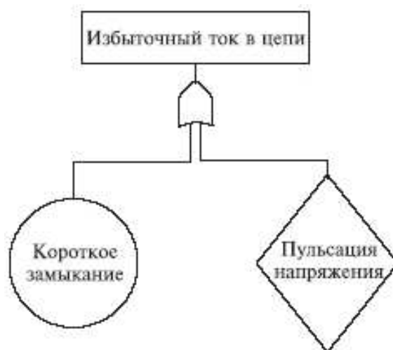
Рис. 3.9. Пример использования символов событий "круг" и "ромб"
