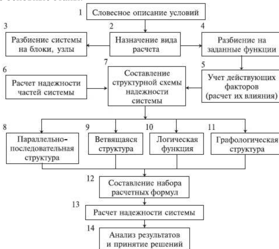
Рис. 2.4. Алгоритм расчета надежности
