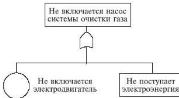
Рис. 3.15. Случай инициированного отказа: внесенная неисправность - "не поступает электроэнергия"
