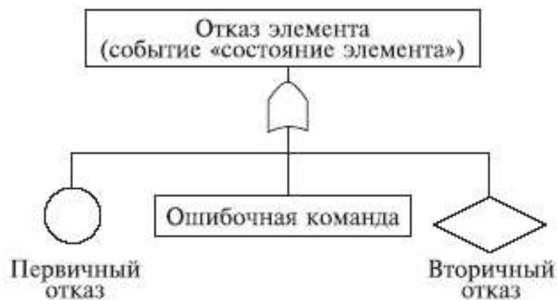
Рис. 3.11. Разработка отказа элемента (событие "состояние элемента")
