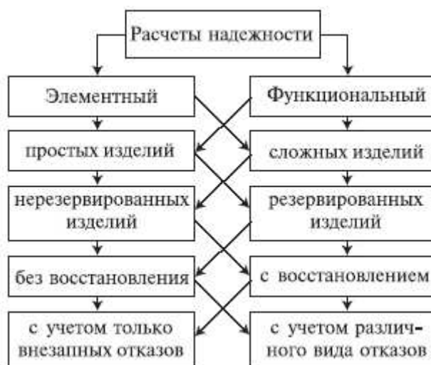
Рис. 2.3 Классификация расчетов надежности
