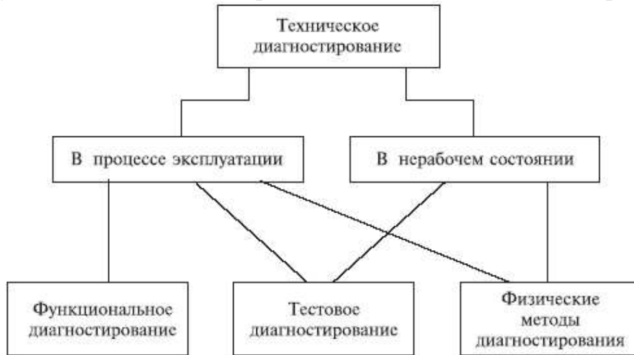
Рис. 4.1. Методы, технического диагностирования
