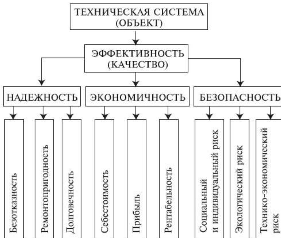
Рис. 2.1. Основные свойства технических систем
