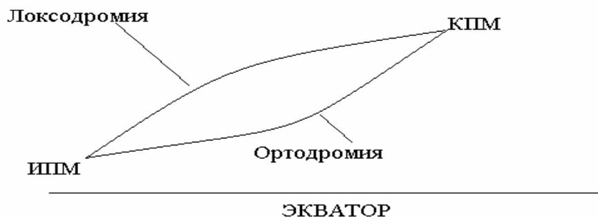
4. Локсодромия уклоняется от ортодромии. Величину бокового уклонения локсодромии применительно к полетным картам, составленным в международной проекции, можно определить по следующей приближительной формуле:
